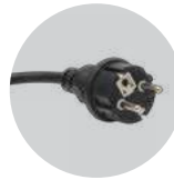
Cavo / Cable / Cable / Câble / Kabel: H0SRN-F3G1.0mm² 80 cm
