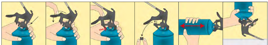
Mounting of the adapter on the manual foam can Befestigung der Adapter auf der manuelle Dose
